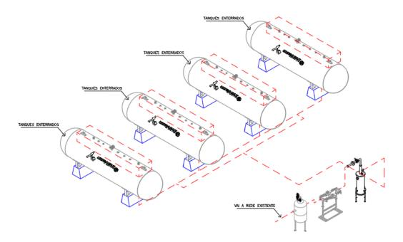
Válvulas e conexões de rosca cônica NPT para pressão de 300lbs/pol<sup>2</sup> para alta pressão e 150lbs/pol<sup>2</sup> para média pressão (após o regulador).
