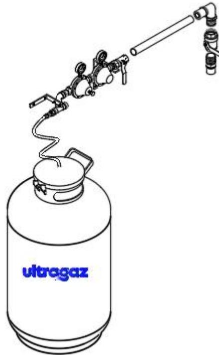
Válvulas e conexões de rosca cônica NPT para pressão de 300lbs/pol<sup>2</sup> para alta pressão e 150lbs/pol<sup>2</sup> para média pressão (após o regulador).
