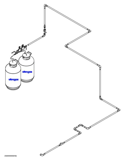
Válvulas e conexões de rosca cônica NPT para pressão de 300lbs/pol² para alta pressão e 150lbs/pol² para média pressão (após o regulador).
