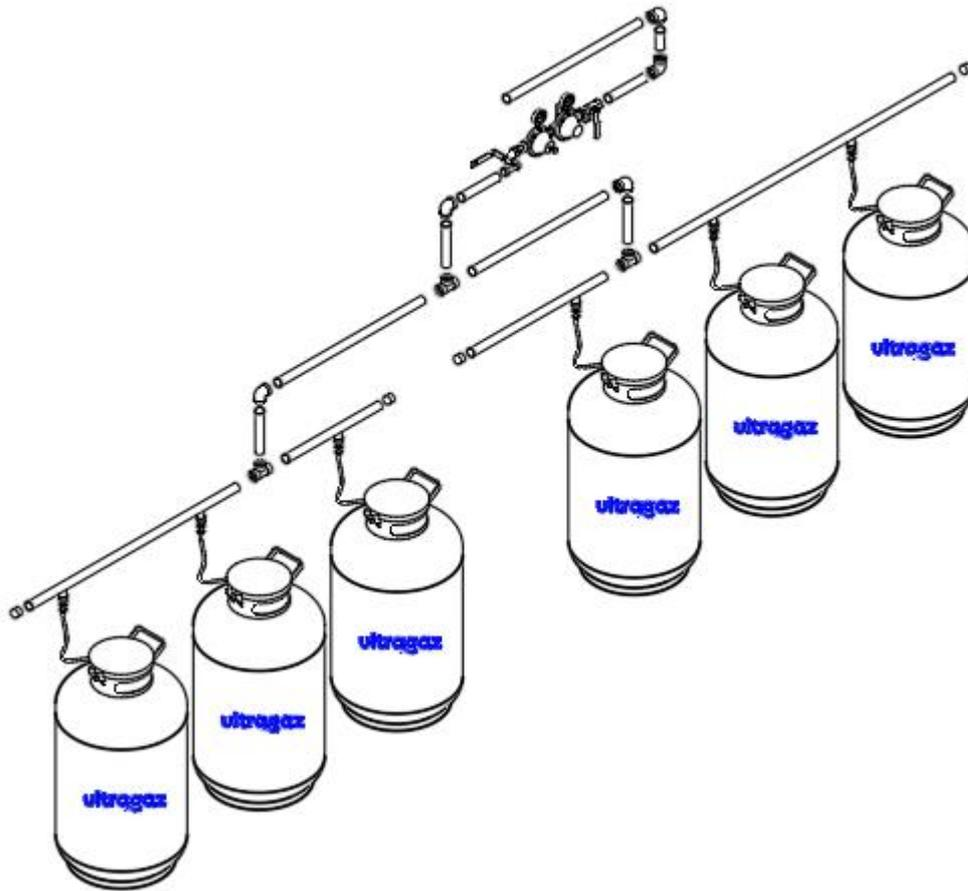
Válvulas e conexões de rosca cônica NPT para pressão de 300lbs/pol<sup>2</sup> para alta pressão e 150lbs/pol<sup>2</sup> para média pressão (após o regulador).
