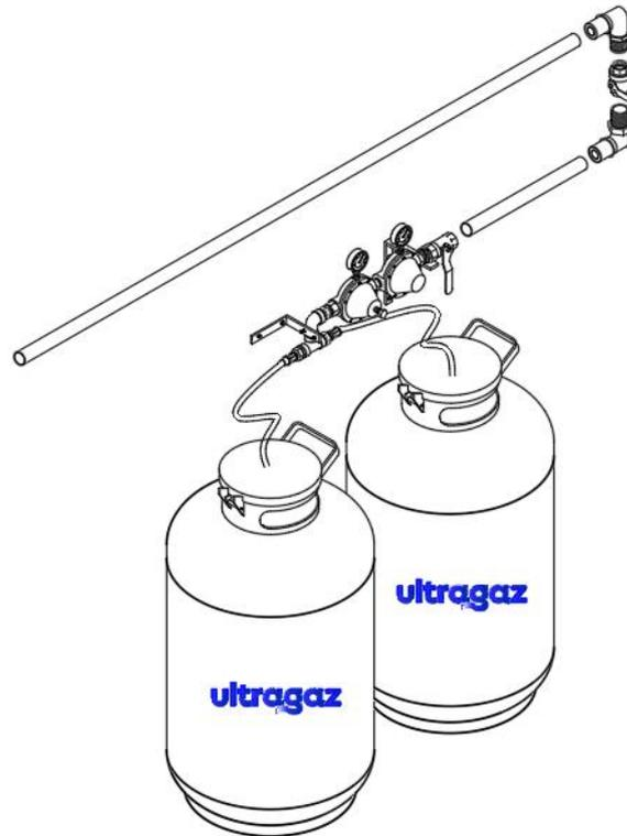
Válvulas e conexões de rosca cônica NPT para pressão de 300lbs/pol<sup>2</sup> para alta pressão e 150lbs/pol<sup>2</sup> para média pressão (após o regulador).
