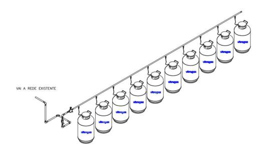
Válvulas e conexões de rosca cônica NPT para pressão de 300lbs/pol² para alta pressão e 150lbs/pol² para média pressão (após o regulador).
