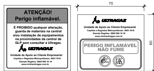
DETALHE DA PLACA DE SINALIZAÇÃO ESC: 1/20
