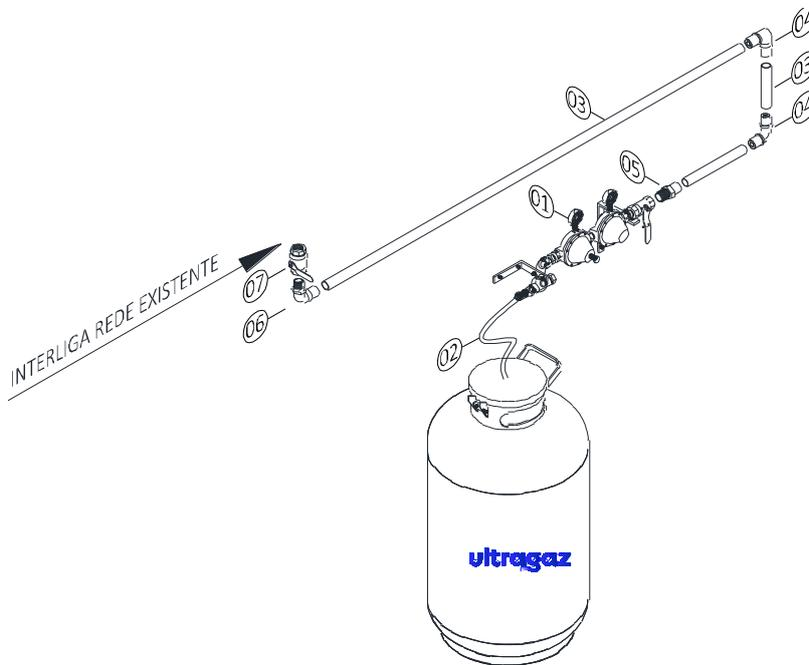
Válvulas e conexões de rosca cônica NPT para pressão de 300lbs/pol<sup>2</sup> para alta pressão e 150lbs/pol<sup>2</sup> para média pressão (após o regulador).
