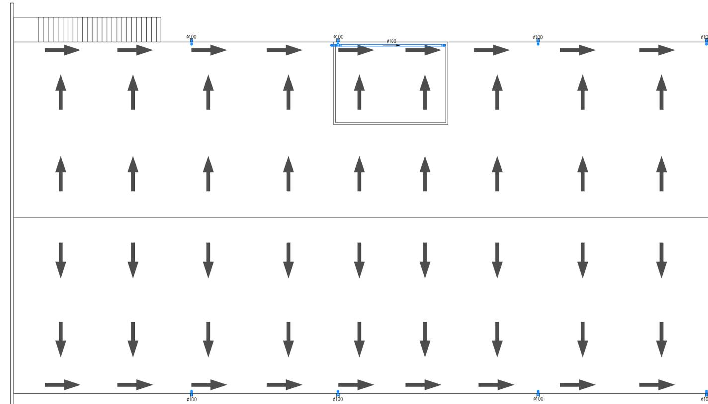
PLANTA DE FLUXO, DIREÇÕES E DESCIDAS DE ÁGUAS PLUVIAIS NO TELHADO
