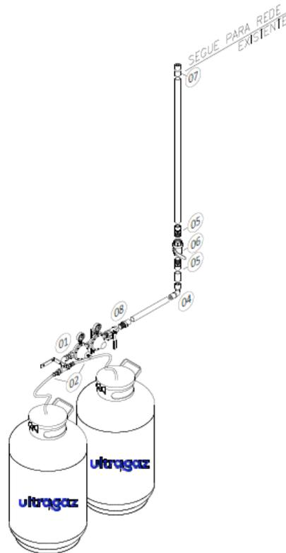
Válvulas e conexões de rosca cônica NPT para pressão de 300lbs/pol<sup>2</sup> para alta pressão e 150lbs/pol<sup>2</sup> para média pressão (após o regulador).
