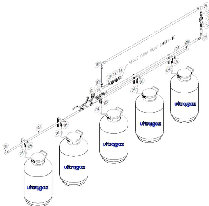
Válvulas e conexões de rosca cônica NPT para pressão de 300lbs/pol<sup>2</sup> para alta pressão e 150lbs/pol<sup>2</sup> para média pressão (após o regulador).
