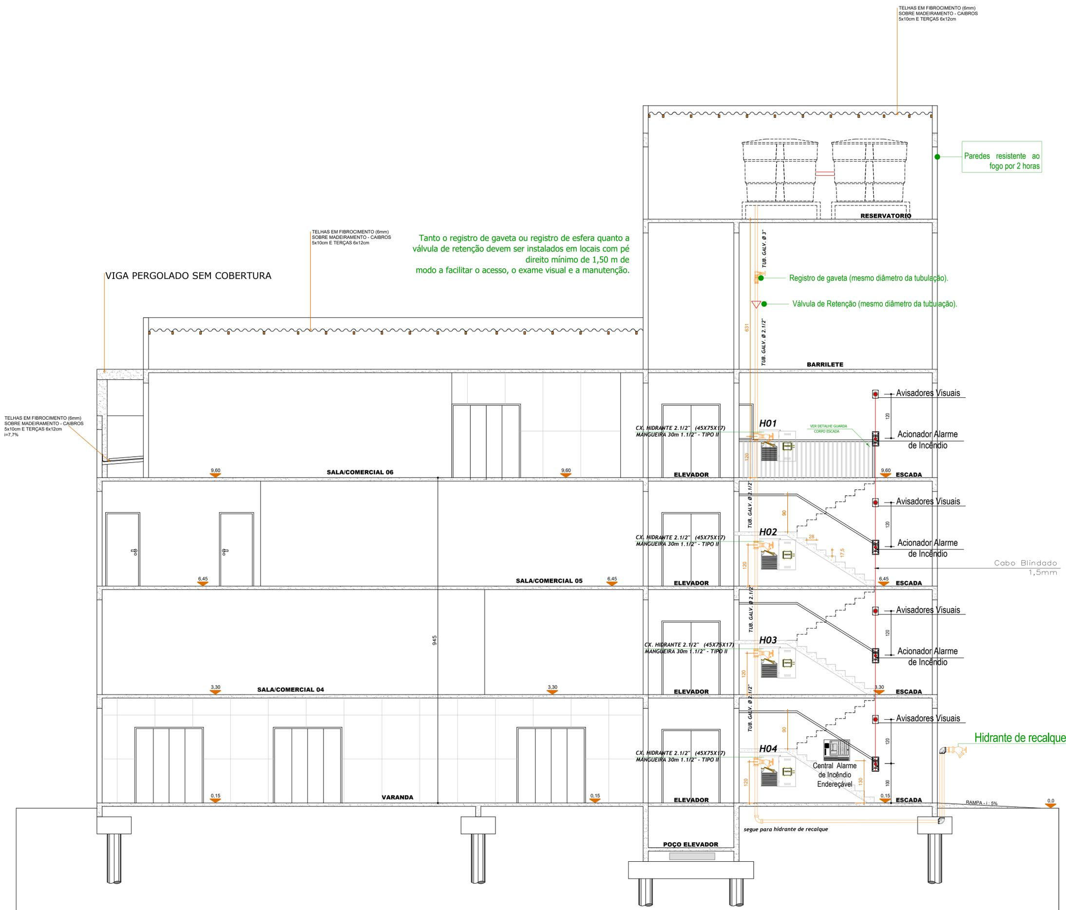
Tanto o registro de gaveta ou registro de esfera quanto a válvula de retenção devem ser instalados em locais com pé direito mínimo de 1,50 m de modo a facilitar o acesso, o exame visual e a manutenção.
