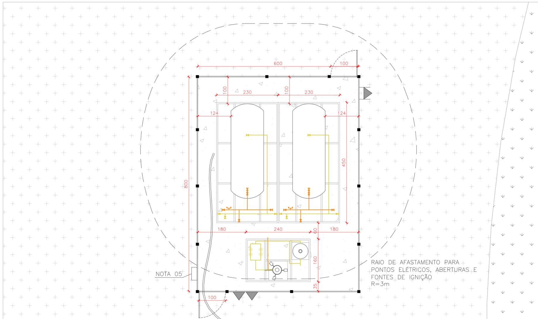
RAIO DE AFASTAMENTO PARA PONTOS ELÉTRICOS, ABERTURAS E FONTES DE IGNIÇÃO R=3m
