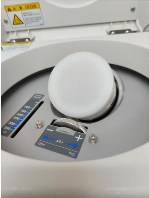
A detecção de desbalanceamento é feita pelo acionamento de alarme e mensagem de erro no visor do equipamento. Neste caso, basta ajustar o balanceamento de acordo com o peso corretamente.
